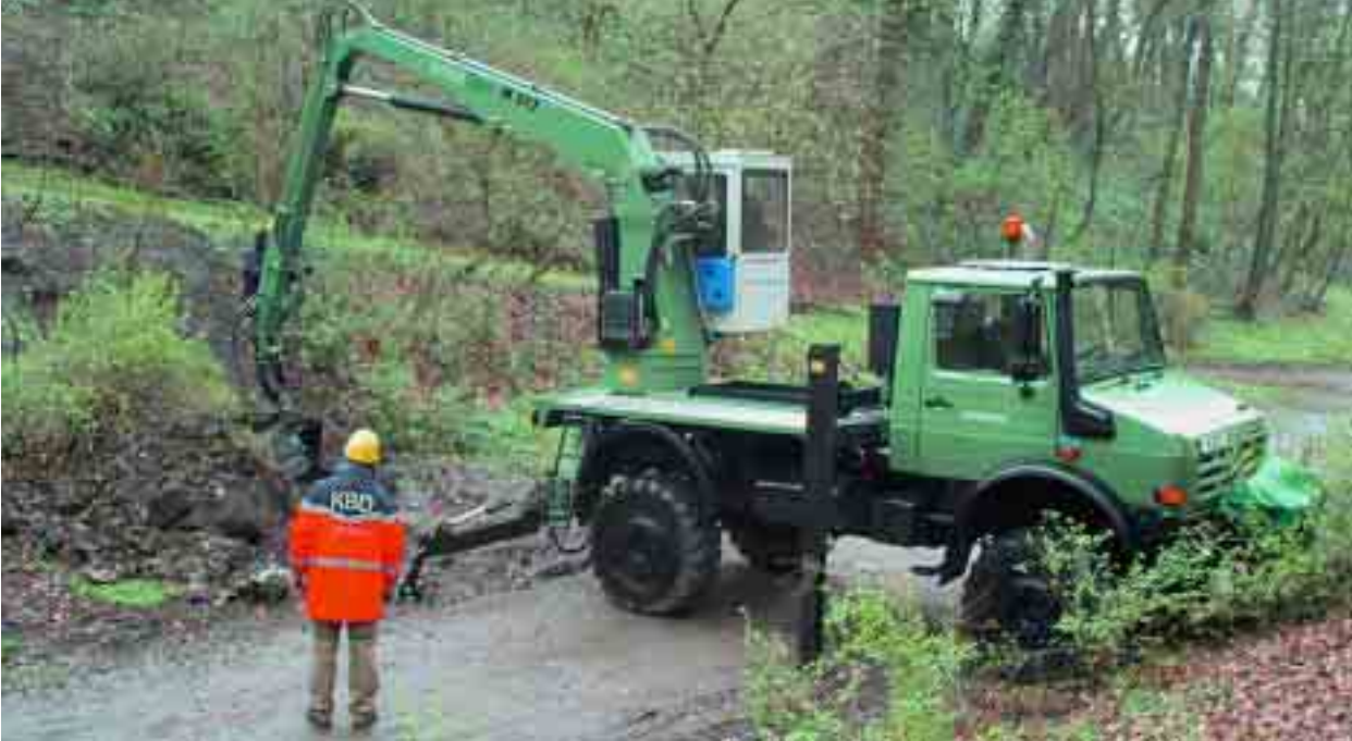
U 5000 mit Eimatec Bagger M 213: Für den Kampfmittelbeseitigungsdienst (KBD) der Bezirksregierung Hannover eine unerlässliche Arbeitseinheit
