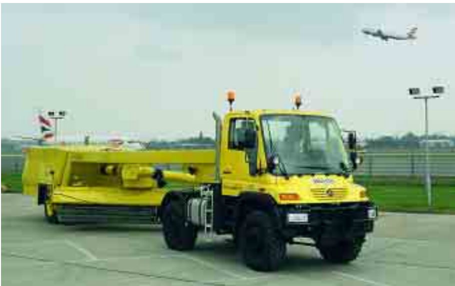
Unimog U 400 mit kurzem Radstand und Sattelkupplung mit einer Kehrmaschine von Bucher-Schörling auf dem Londoner Flughafen Gatwick. Für Großbritannien werden die Unimog in Rechtslenkerversion geliefert, so dass auch die Steuergeräte entsprechend angepasst werden müssen (rechts)
